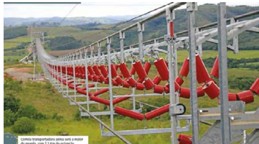
Correia transportadora aérea será a maior do mundo, com 7,2 km de extensão
